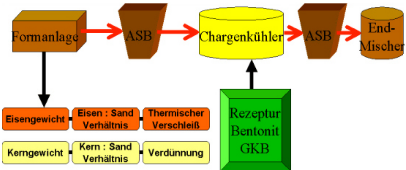
Bild 3: Anlagenschema mit Chargenmischer
